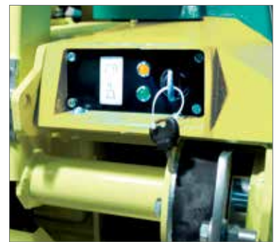
• Elektrostart • Ölmangelsicherung • Startwiederhol sperre und automatische Abschaltung bei längerem Motorstill stand vermeidet das Entla den der Batterie (nur bei Modell APH 100-20)
